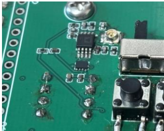
↑ 基板上的リフローでつけた細かい部品
